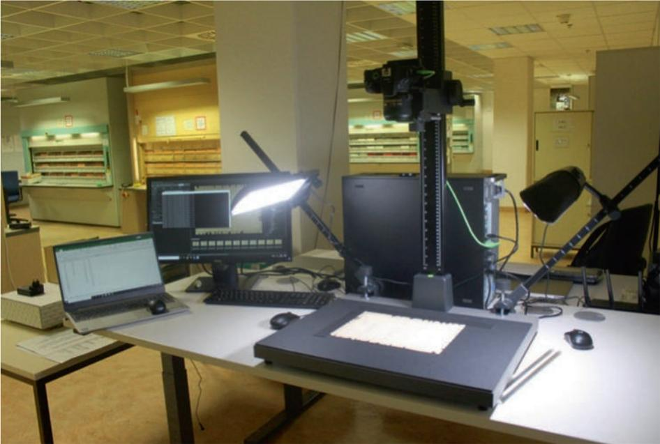
**Abb. 7.2** Repro-Anlage im Karteilesaal des Stasi-Unterlagen-Archivs. Ein hochauflösender Fotoapparat nimmt das Digitalisat auf, wobei eine eigens angefertigte Schablone eine identische Positionierung jeder Karteikarte sicherstellt. Die Kartei umfasst ca. 67.500 Karten
